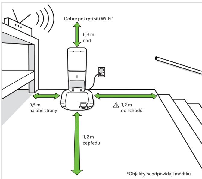
**VAROVÁNÍ:** Abyste zabránili riziku pádu robota ze schodů, ujistěte se, že se nabíjecí stanice nachází nejméně 1,2 metru od schodů.
