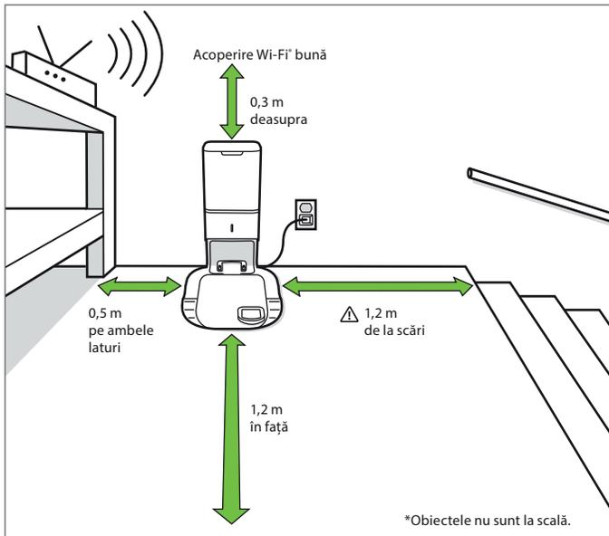
**⚠️ AVERTISMENT:** Pentru a preveni riscul căderii pe scări a robotului dvs., asigurați-vă că stația de încărcare este amplasată la o distanță de cel puțin 1,2 metri de la scări.
